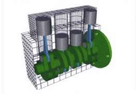
Slika 14. Shema 4-cilindričnog motora SUI [21]
