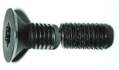
Slika 2. Lom vijka uslijed preopterećenja [12]
