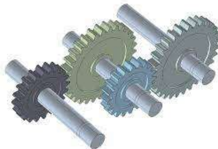
Slika 6. Shema složenog zupčanog prijenosa [16]
