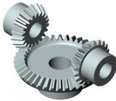
Slika 4. Zupčani prijenos sa stožastim zupčanicima [14]
